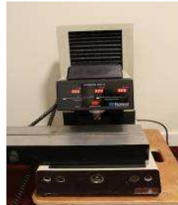
削り、彫りなどに使用した CAMM-3 という機械
