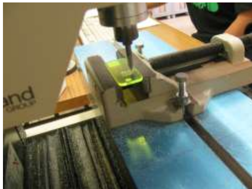
キーホルダー切削作業 キーホルダー本体から名前の掘り出し
